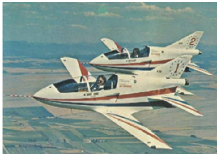
178 кг, а максимальная взлетная – 530 кг. Неудивительно, что самолет развивал максимальную скорость в 322 км/ч и обладал практической дальностью чуть более 1 100 км. С крейсерской скоростью он мог находиться в воздухе до четырех часов. Более того, самолет был очень экономичен: на одном галлоне топлива пролетал 40 миль, что соответствовало расходу 5,88 литра на 100 км.
